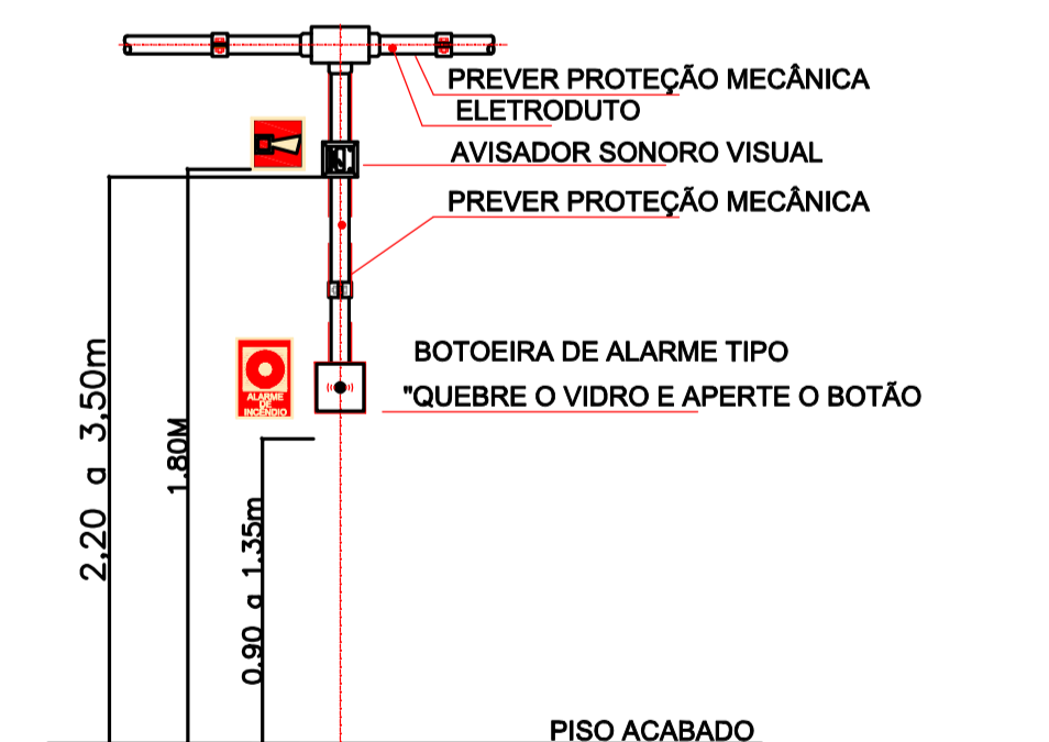
DETALHE DA INSTALAÇÃO DA BOTOEIRA DE ALARME E AVISADOR SONORO
