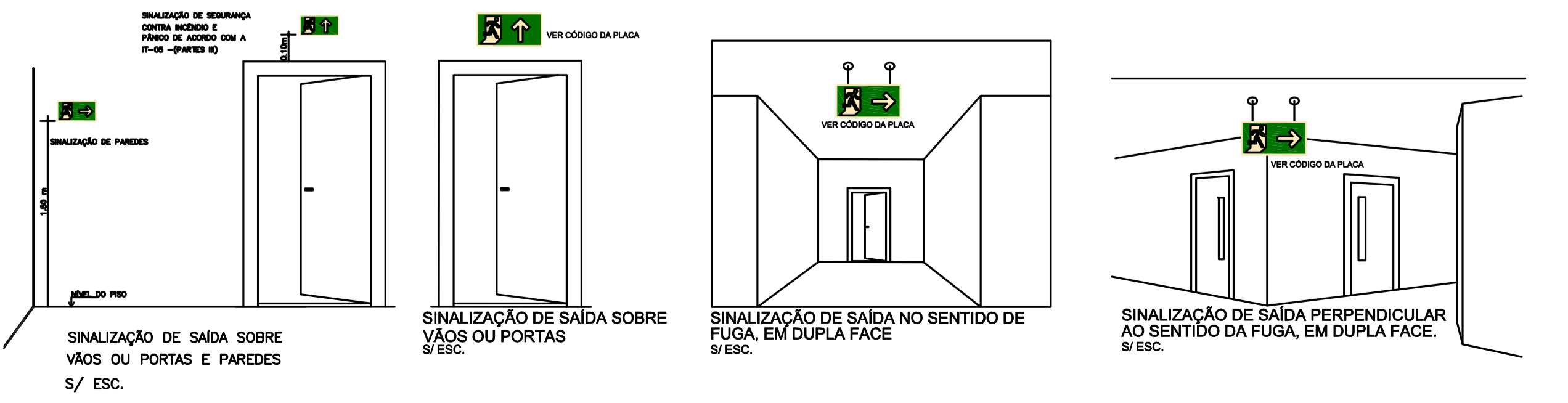
SINALIZAÇÃO DE SEGURANÇA CONTRA INCÊNDIO E PAINEL DE ACIONAMENTO COM A IT-05 - PARTE III
